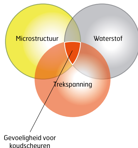
AFBEELDING 3. DE GEVOELIGHEID VOOR KOUDSCHEUREN VAN EEN LASVERBINDING IS HET NADELIGE COMBI-EFFECT VAN DRIE FACTOREN.
