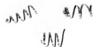
Leicht gewellte Späne. Optimaler Vorschub
