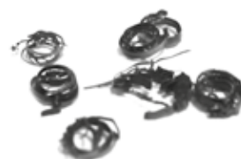
Dicke, raue oder verbrannte Späne. Vorschub/Drehzahl verringern
